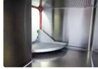
Hava kilit özellikli, cam kapaklı, ergonomik kayar tepsi sistemli ve kolay kullanım dinamik hava bariyer kontrollü malzeme transfer penceresi
