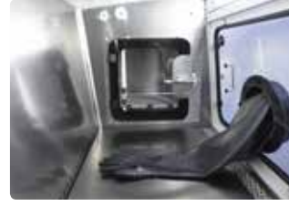
Kontaminasyon riski minimize edilmiş Sızdırmaz eldiven girişli tam izole birincil bariyer
