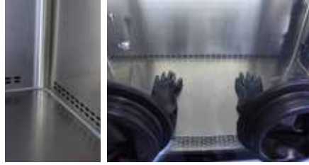
İzolator çalışma kabini
