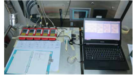
Şekil 4. 5 odalı bir BSL-3 laboratuvarı için fark basınç grafiği kayıt ekipmanı.
